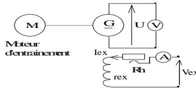
Faire varier le courant d'excitation de la génératrice de 0 à  $1.25 I_{exc nom}$  par valeurs croissante puis par valeurs décroissante de  $1.25 I_{exc nom}$  à 0 afin de relever le cycle d'hystérésis du circuit magnétique de la machine.
